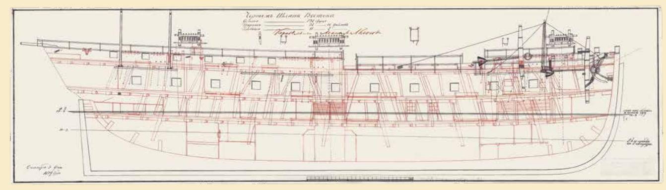
Шлюп «Мирный»: водоизмещение — 884,5 т, наибольшая длина — 43,3 м, ширина с обшивкой — 9,55 м, осадка форштевнем (носом) — 4,17 м и ахтерштевнем (кормой) — 4,11 м, площадь парусности — 1420,18 м², скорость хода — до 8 узлов, вооружение — 20 орудий, экипаж — 72 человека (8 офицеров и ученых, 5 унтер-офицеров, 60 матросов).
